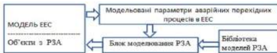
Рис. 1. Блок-схема моделювання аварійних перехідних процесів в ЕЕС з урахуванням функціонування пристроїв РЗА
