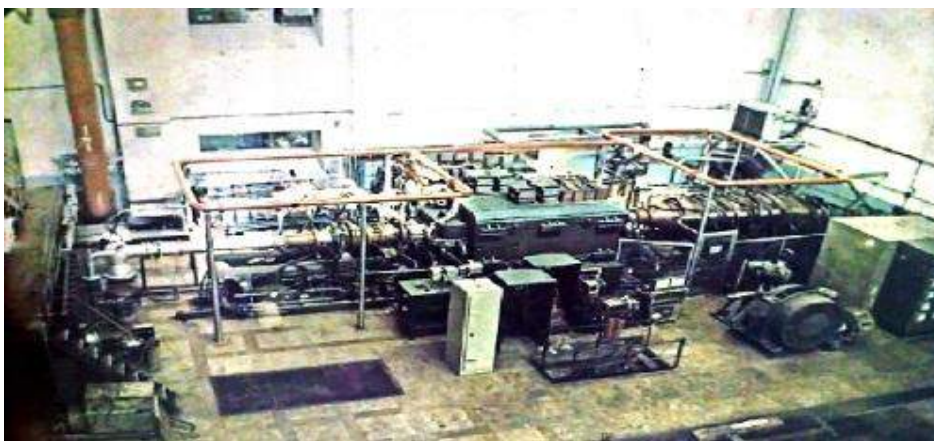
Рис. 2. Експериментальна МГД-установка К-1 електричною потужністю 200 кВт (фото 90-х років минулого століття) [4]
